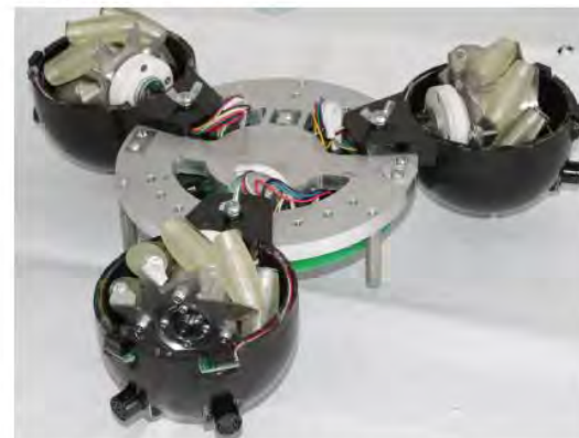
Автономный высокоманевренный мобильный робот с тремя омниколесами
