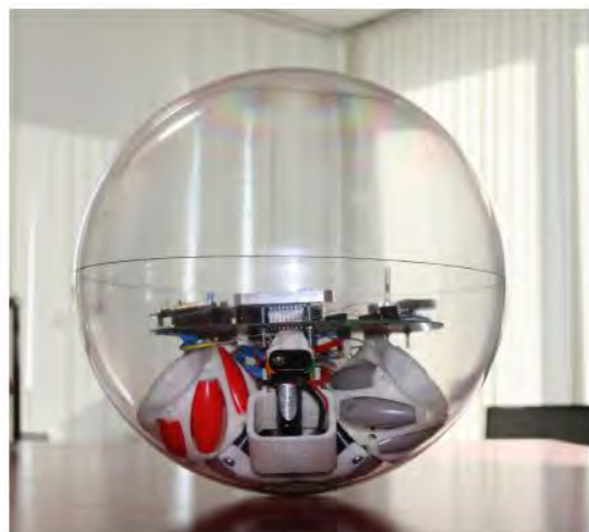
Сфероробот с внутренней омниколесной платформой
