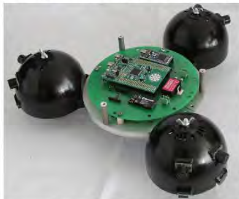
Автономный высокоманевренный мобильный робот с тремя омниколесами
