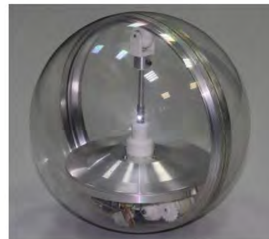
Сфероробот с комбинированным двигателем
