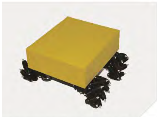
Транспортный мобильный робот с омниколесами
